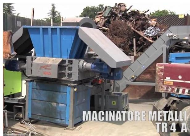
Per assicurare il contenimento delle emissioni sonore, generate durante le fasi di trattamento dei rifiuti prevalentemente di natura metallica, intorno al macchinario più rumoroso (cesoia oleodinamica) se necessario si poseranno in opera dei pannelli fonoisolanti con lastra piombata del tipo "guttasilent".
