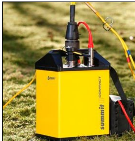
Fig.3 – Sismografo 24 canali modello Compact.
