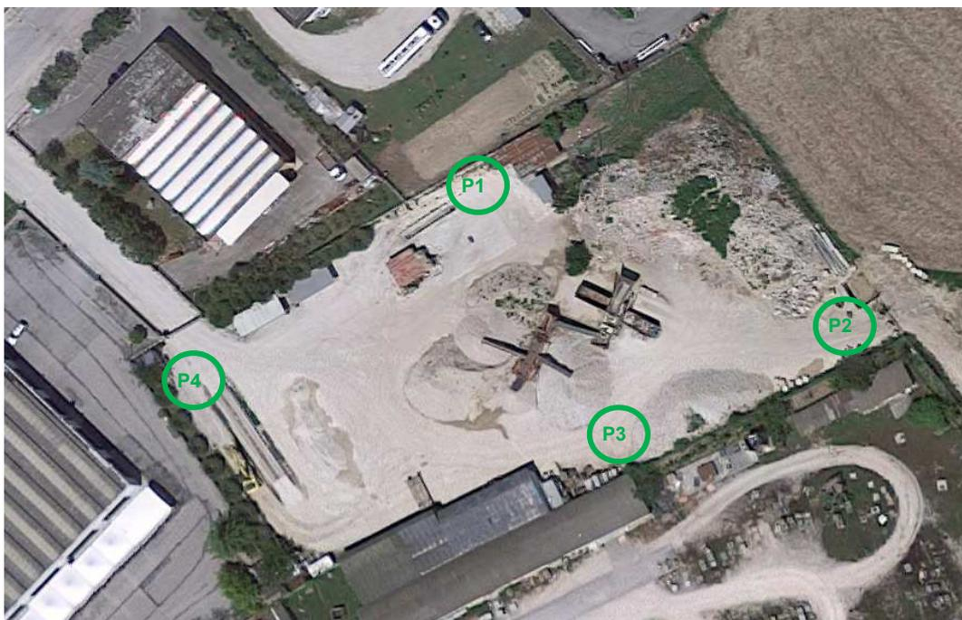
Stralcio aereofotogrammetrico n. 1: **Punti di Campionamento Polveri Aerodisperse**
