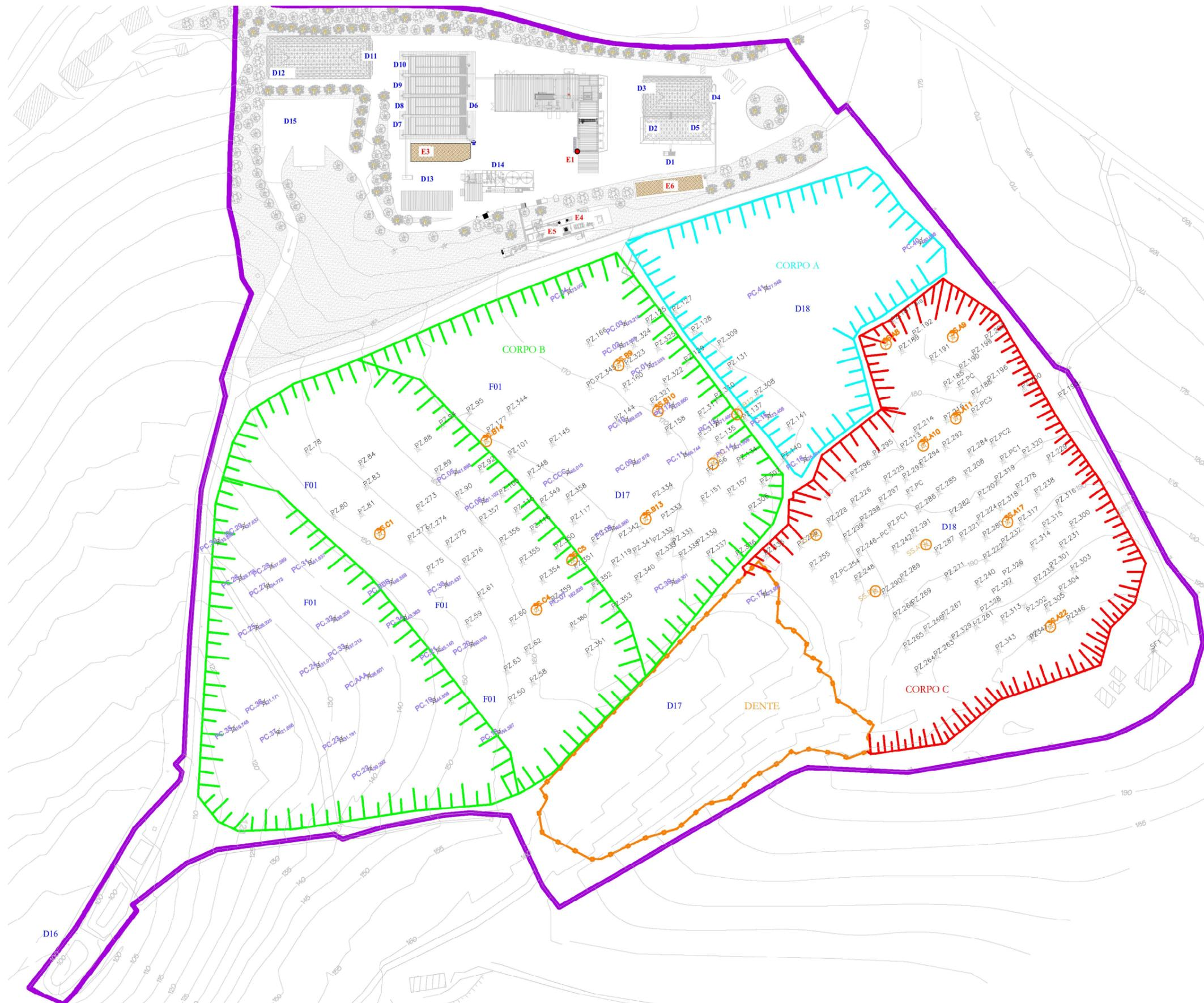
Figura 8: Planimetria con individuazione emissioni diffuse stato Attuale
