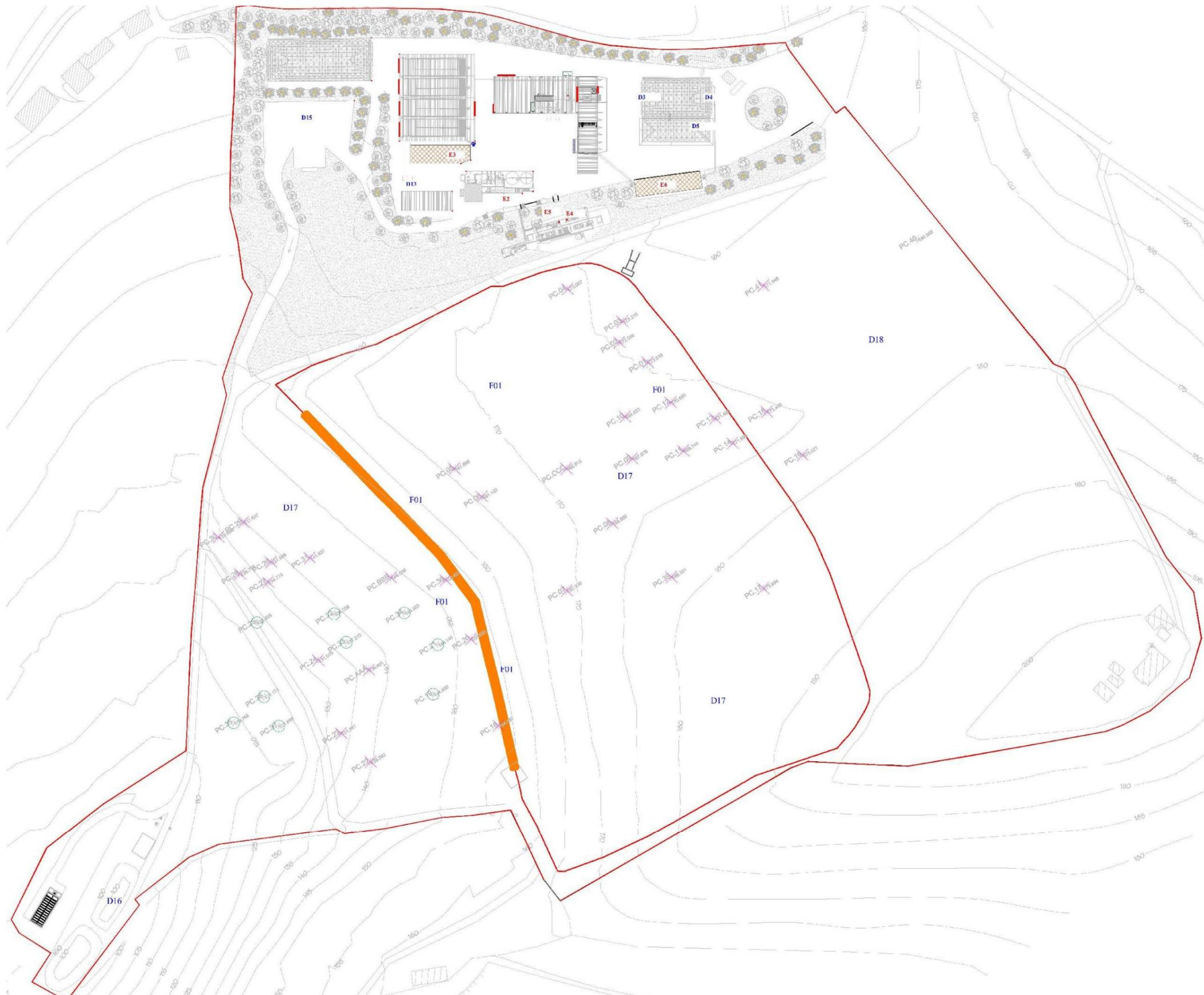
Figura 10: Planimetria con individuazione emissioni diffuse stato modificato
