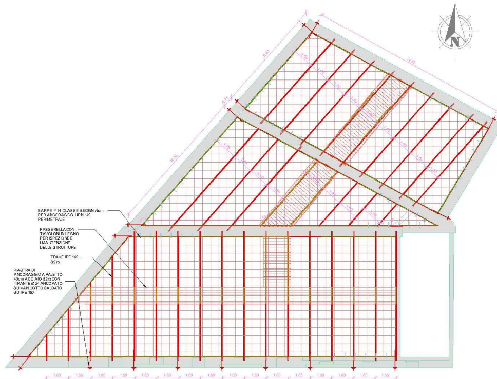
Pianta della nuova struttura di copertura in acciaio
