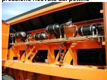
Accumulatore pressione ricevuta dal pettine
