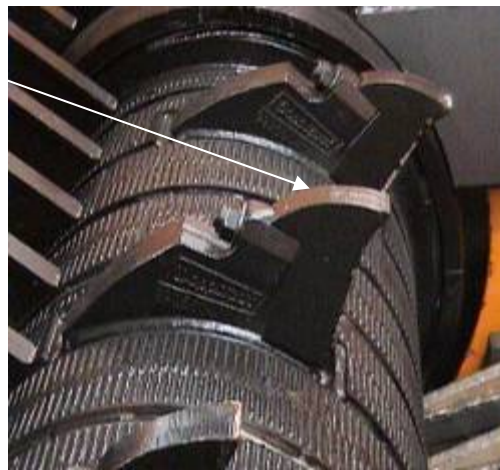
Punta di usura del dente del rotore
