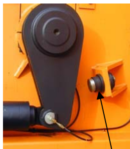
Perno regolazione apertura max pettine
