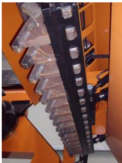
Denti del pettine di triturazione
