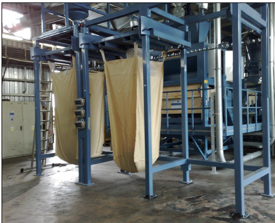
11 Immagine di un sistema di insilaggio con pesatura elettronica
