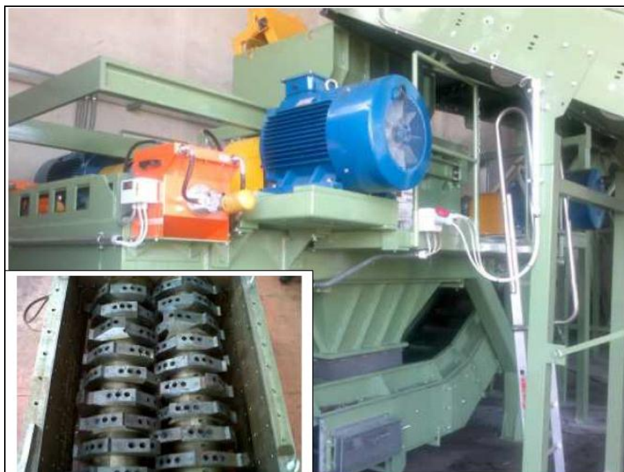
4: Modalità di triturazione dei pneumatici fuori uso
