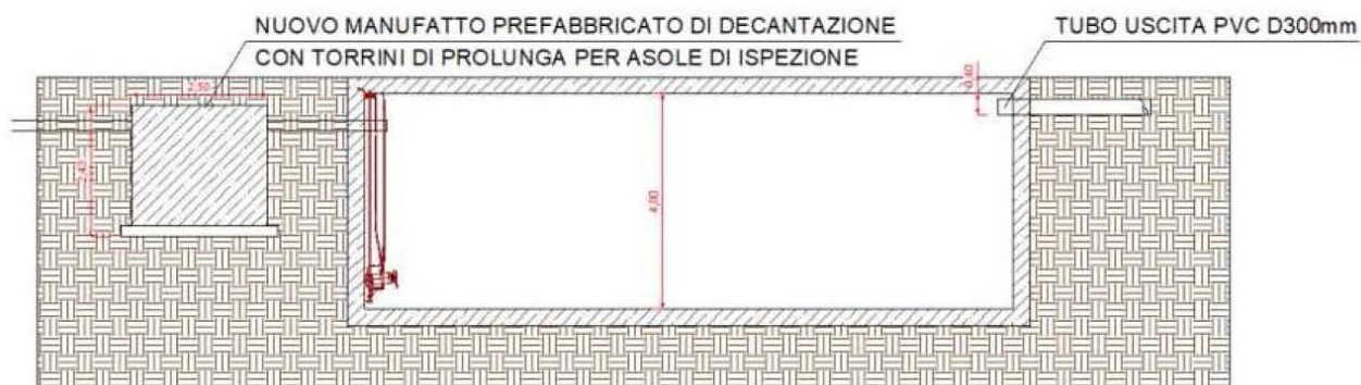
Figura 59: Schema installazione vasca decantazione
