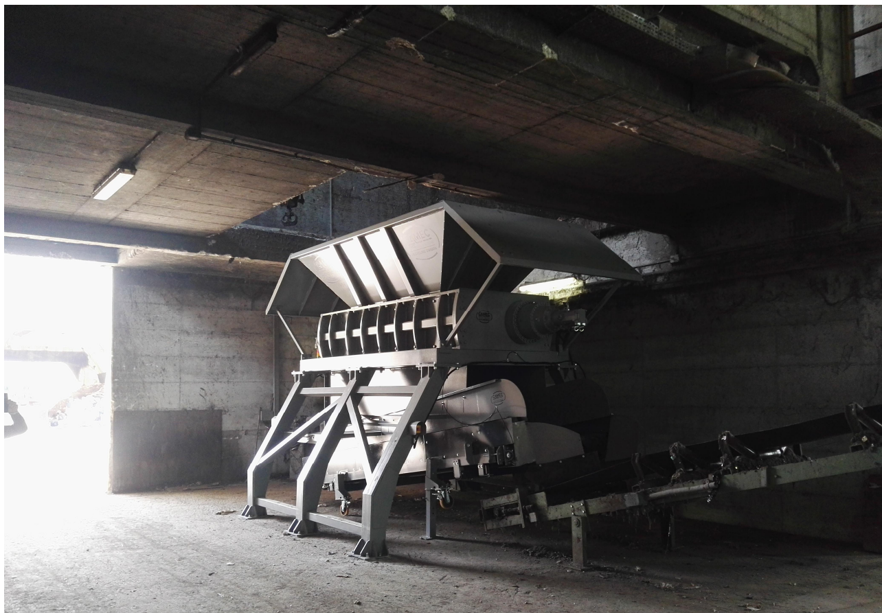
Figura 17: Nuovo trituratore in fase di allestimento
