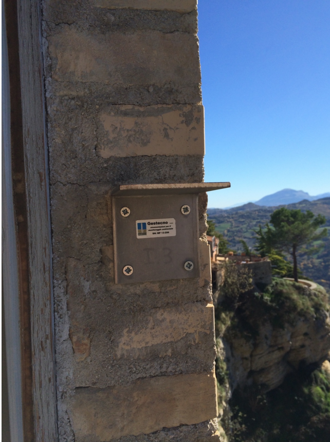
Figura 3 – Base inclinometrica
