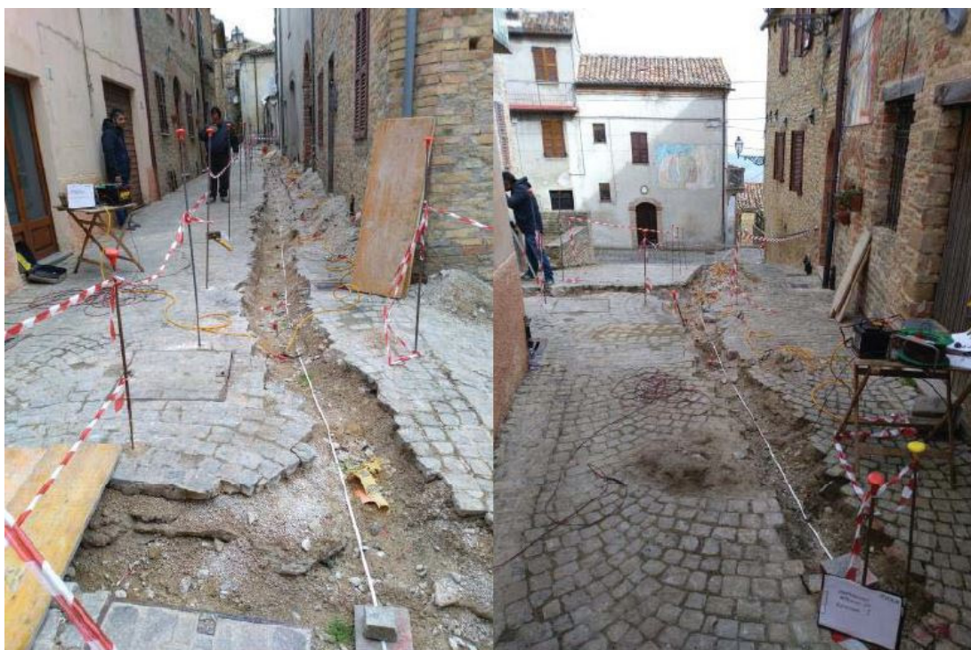
Figura 2 – Linee di indagine sismica a riflessione (Sx -MFA4P – Dx – MFA5P)
