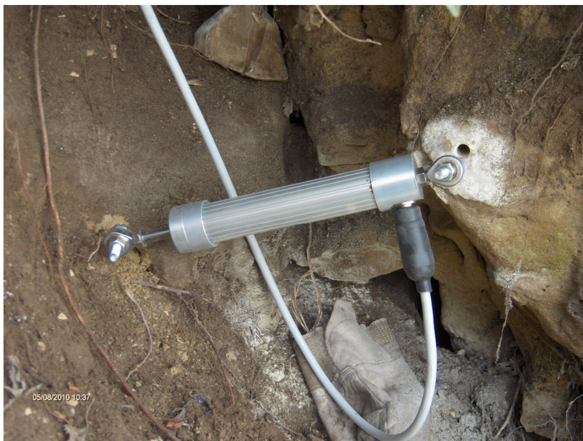
Figura 1 – Fessurimetro
