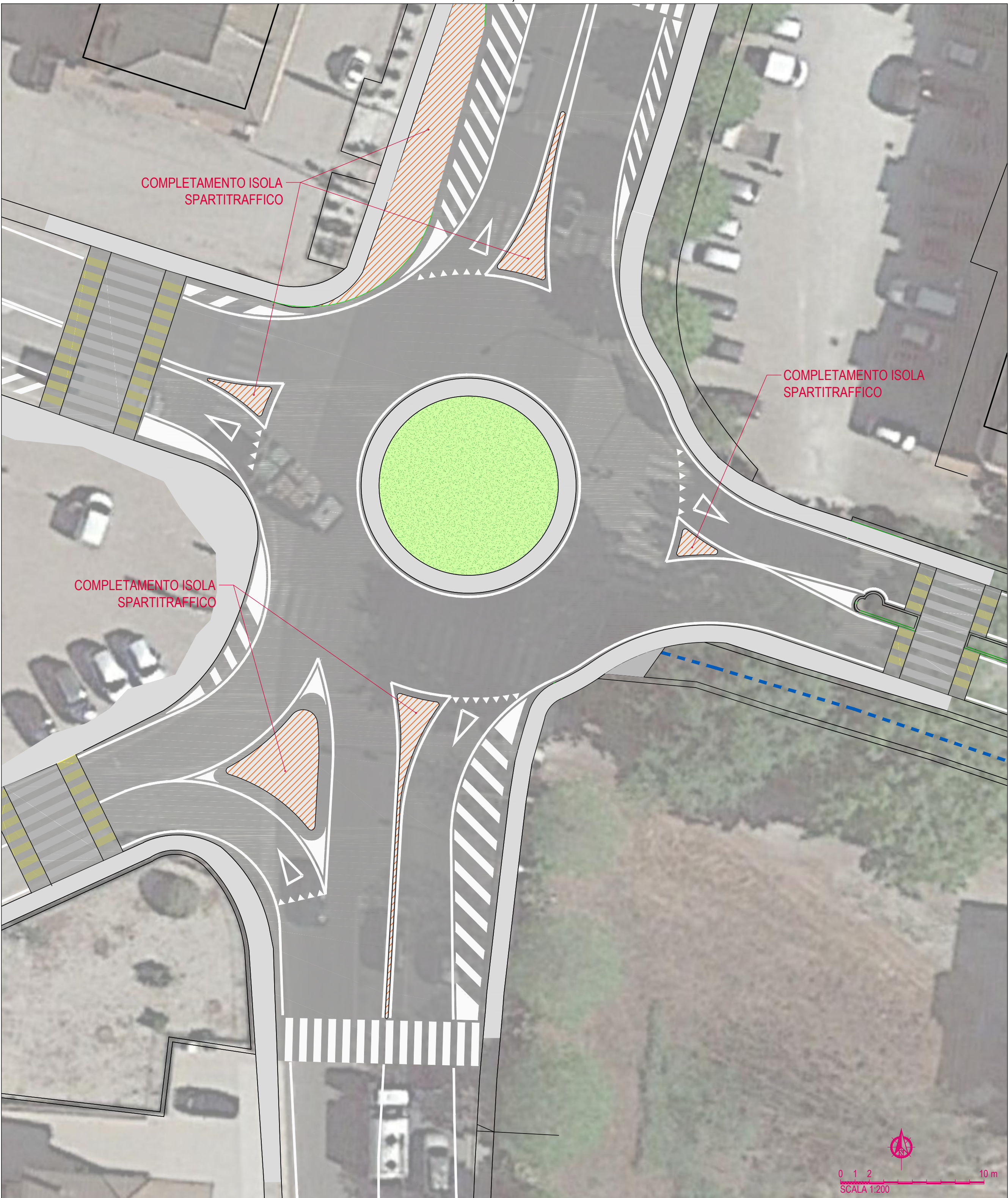
FASE 4 - REALIZZAZIONE ISOLE SPARTITRAFFICO, MANTO ASFALTO E SEGNALETICA DEFINITIVA
