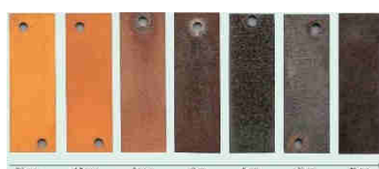
Figura 1 – Colore differente assunto dal COR-TEN in funzione del tempo di esposizione
