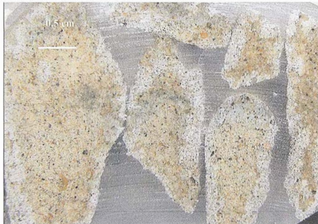
Fig. n. 2 – Sezioni stratigrafiche del campione di malta M4. Si può osservare la tessitura della malta ed il colore degli aggregati a granulometria maggiore
