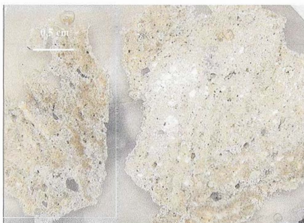
Fig. n. 2 – Sezioni stratigrafiche del campione di malta M2. Si individua la tessitura della malta e colore degli aggregati
