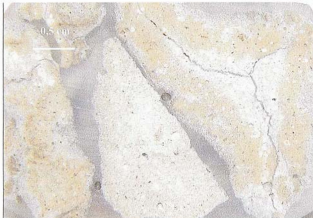
Fig. n. 2 – Sezioni stratigrafiche del campione di malta. Si osserva la tessitura della malta, la porosità e i grumi bianchi di legante.
